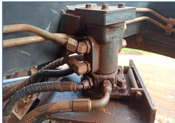
IMAGENS DE MANGUEIRAS DA MÁQUINA QUE POSSUEM VAZAMENTO
