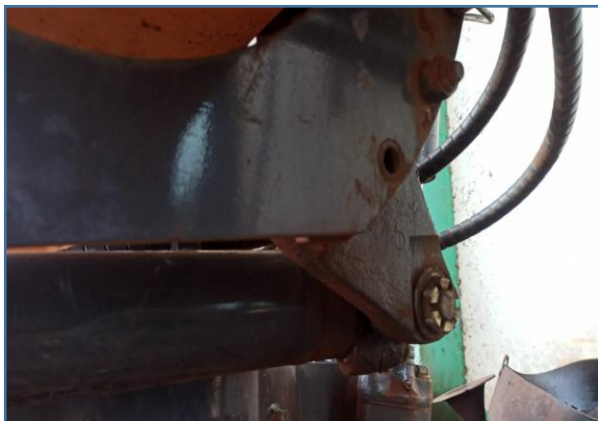
IMAGENS DETALHADAS DA AUSÊNCIA DE PARAFUSO DE FIXAÇÃO
