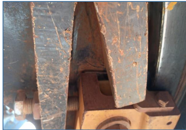
IMAGEM INFERIOR DETALHADA DO GIRA CÍRCULO QUE ESTÁ COM SEUS CALÇOS DESGASTADOS
