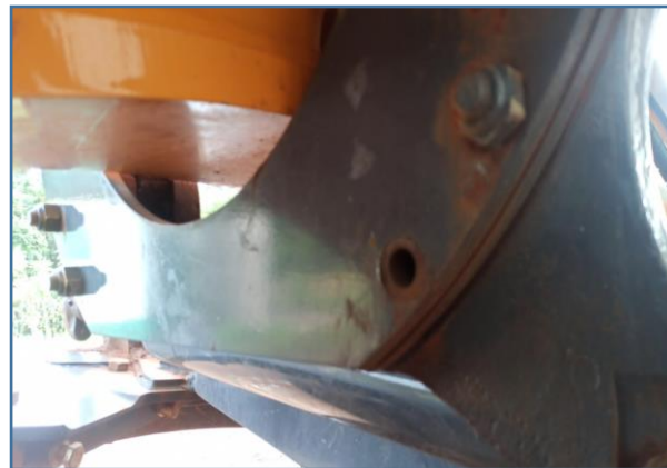
IMAGENS DETALHADAS DA AUSÊNCIA DE PARAFUSO DE FIXAÇÃO
