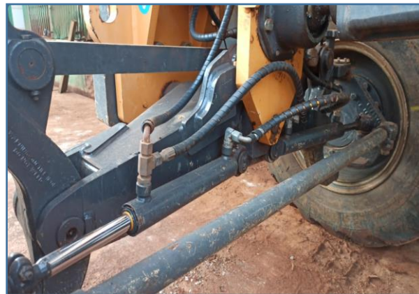
IMAGEM DO EIXO DIANTEIRO QUE POSSUI SEVERA TRINCA
