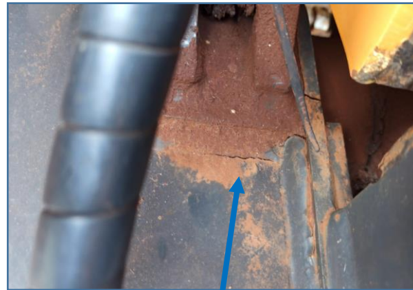
IMAGENS DETALHADAS DA TRINCA DO EIXO DIANTEIRO
