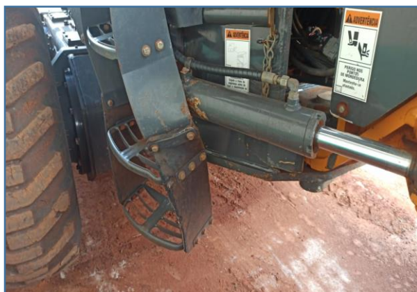
IMAGENS DO ESTRIBO DA MÁQUINA QUE DEVE SER CONSERTADO
