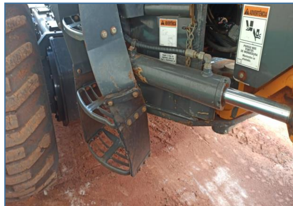
IMAGENS DO ESTRIBO DA MÁQUINA QUE DEVE SER CONSERTADO
