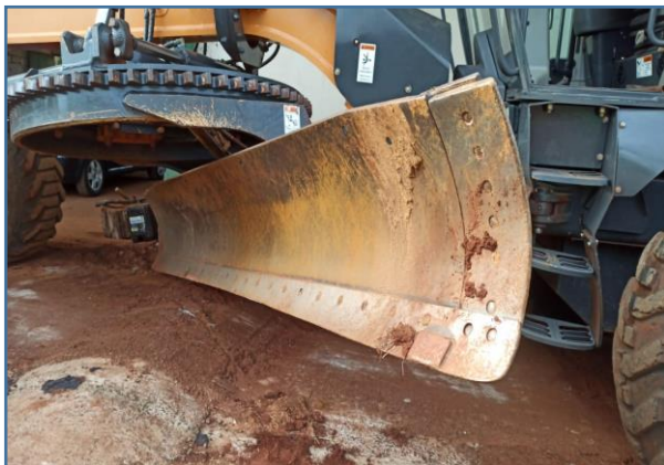
IMAGENS DA LÂMINA DA MÁQUINA QUE NECESSITA DE REPAROS NAS SUAS CHAPAS DE DESGASTE E CALÇOS
