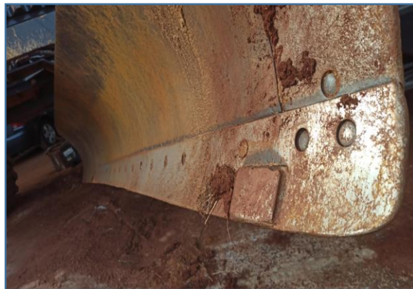
IMAGENS DA LÂMINA DA MÁQUINA QUE NECESSITA DE REPAROS NAS SUAS CHAPAS DE DESGASTE E CALÇOS
