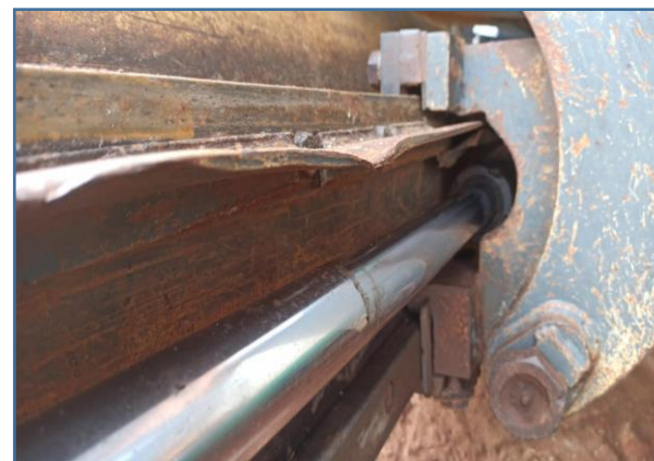
IMAGENS DO PISTÃO HIDRÁULICO DA MÁQUINA QUE ESTÁ DANIFICADO
