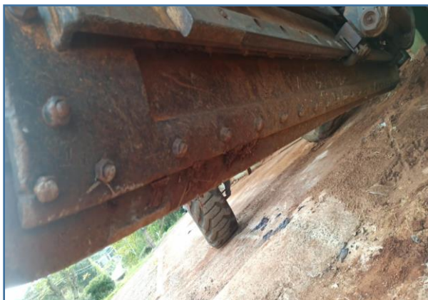
IMAGEM INFERIOR DETALHADA DA LÂMINA DA MÁQUINA QUE NECESSITA DE REPAROS EM SUAS CHAPAS DE DESGASTE E CALÇOS
