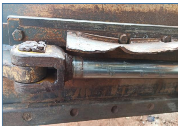
IMAGENS DO PISTÃO HIDRÁULICO DA MÁQUINA QUE ESTÁ DANIFICADO
