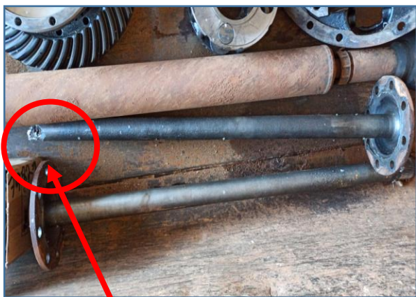
IMAGEM DO SEMI-EIXO QUEBRADO
