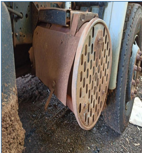
IMAGEM DO SILENCIOSO DA DESCARGA QUE ESTÁ TOTALMENTE DANIFICADO
