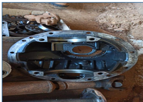
IMAGEM DA CARÇA DO CONJUNTO DIFERENCIAL DANIFICADA
