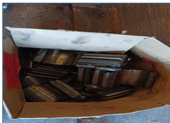
IMAGENS COM DIVERSOS ITENS DO CONJUNTO DE DIFERENCIAL QUE ESTÁ DANIFICADO
