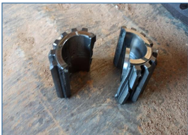
IMAGEM DETALHADA DE ENGRENAGEM DA CAIXA SATELITE QUE ESTÁ QUEBRADA
