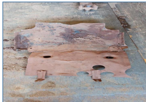
IMAGEM DETALHADA DA PROTEÇÃO DO MOTOR QUE ESTÁ DANIFICADA
