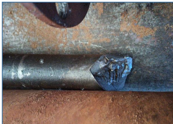
IMAGEM COM DETALHE DO SEMI-EIXO QUEBRADO
