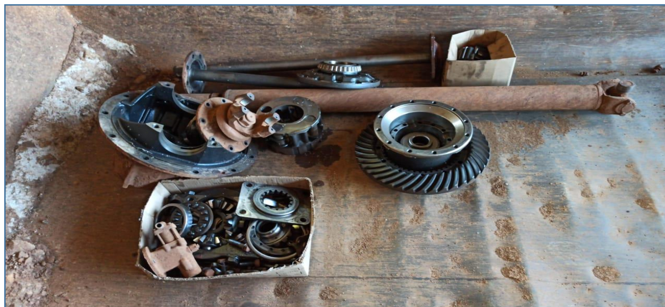
IMAGEM DE COMPONENTES MECÂNICOS DO CONJUNTO DE DIFERENCIAL JÁ DESMONTADOS
