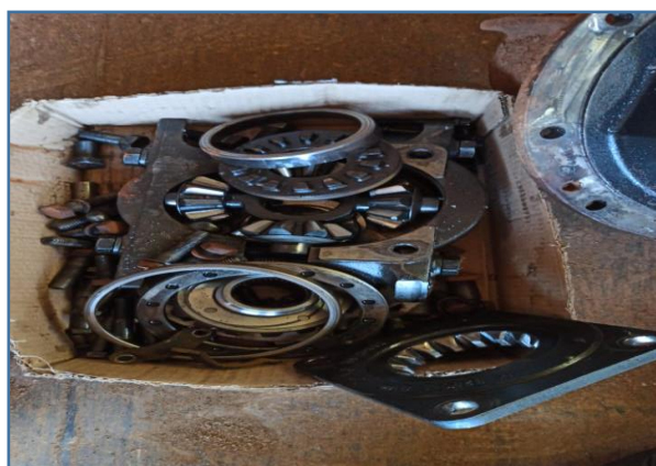
IMAGENS COM DIVERSOS ITENS DO CONJUNTO DE DIFERENCIAL QUE ESTÁ DANIFICADO
