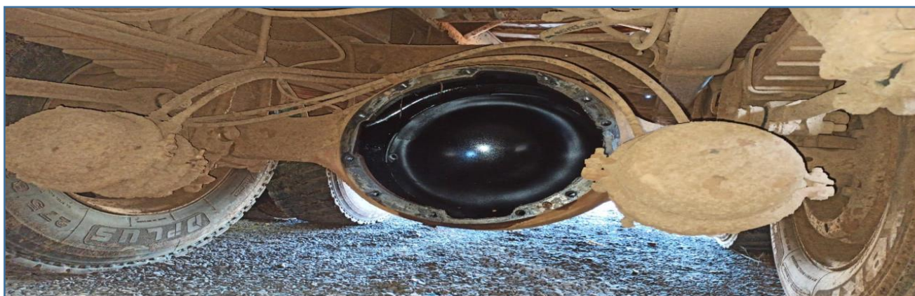
IMAGEM DA CARÇA DO CONJUNTO DIFERENCIAL JÁ DESMONTADA
