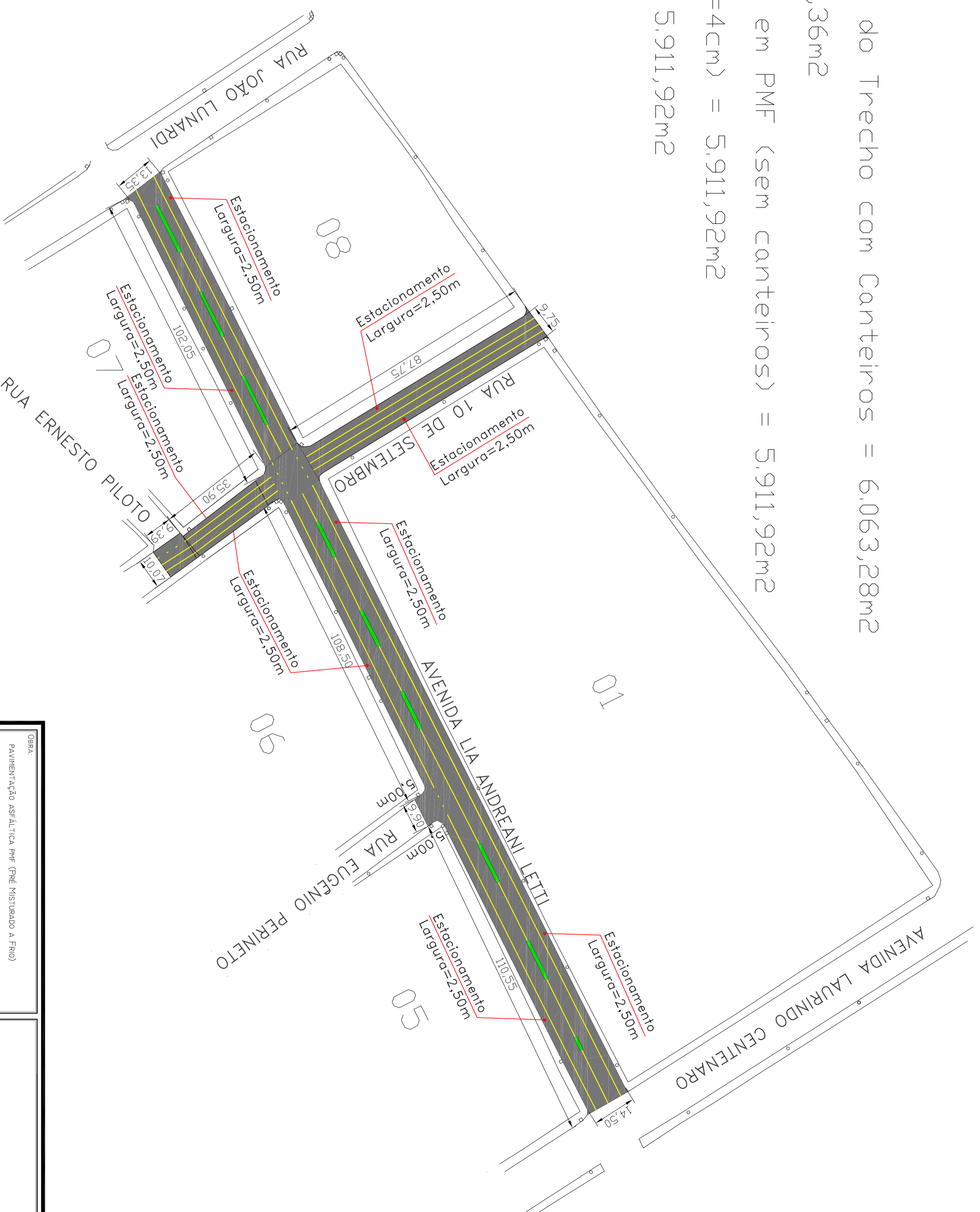
PLANTA CAPEAMENTO ASFÁLTICO EM PMF ESCALA 1:1.000
