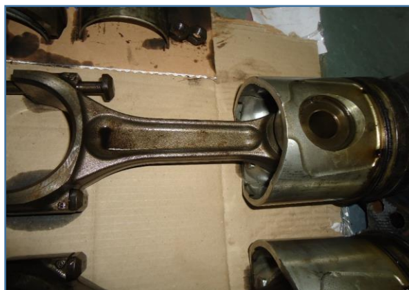
PISTÕES E BIELAS E DETALHE DE PISTÃO E BIELA. OBS: AS BIELAS NÃO NECESSITAM SER SUBSTITUÍDAS.
