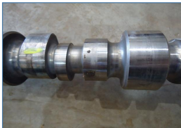
DETALHE EIXO DO COMANDO DANIFICADO
