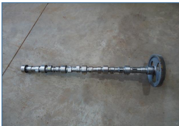
EIXO DO COMANDO DANIFICADO
