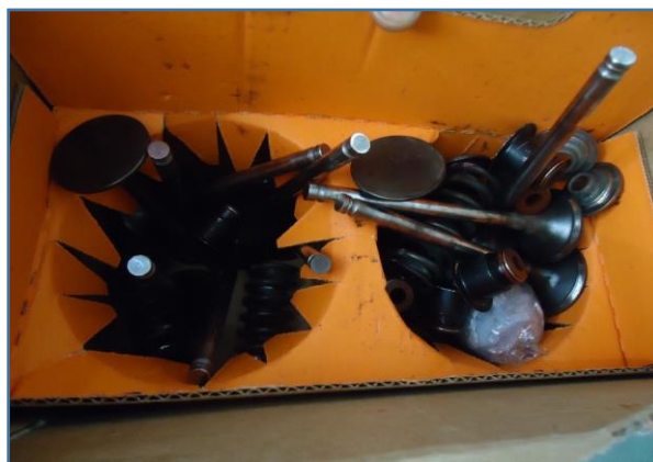
VÁLVULAS DE ADMISSÃO E ESCAPE DANIFICADAS
