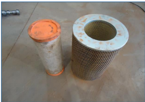
FILTROS DE AR DANIFICADOS
