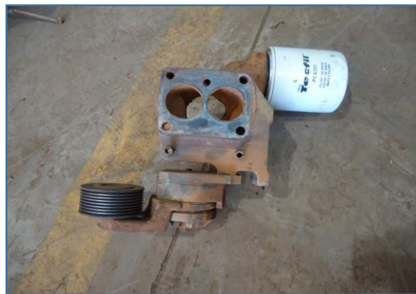
FILTRO DE ÁGUA ANTI CORROSIVO DANIFICADO
