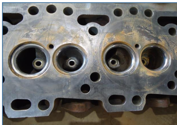
DETALHE CABEÇOTE DO MOTOR DANIFICADO
