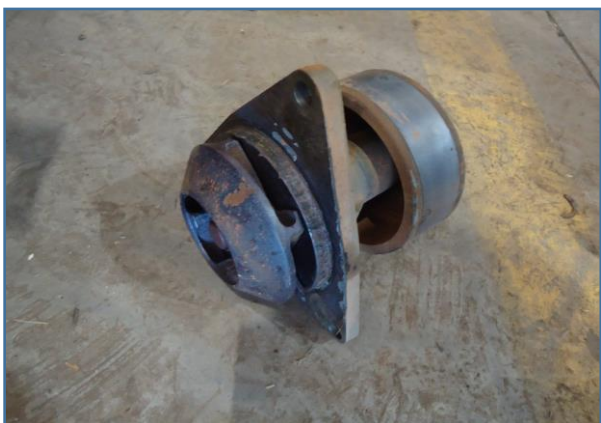
BOMBA DE ÁGUA DANIFICADA
