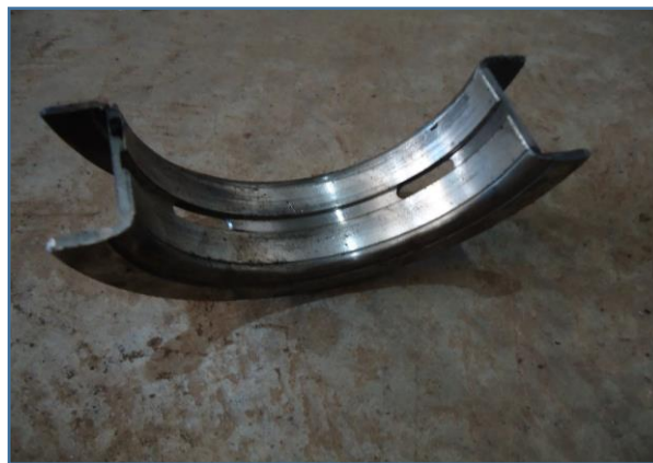
DETALHE DE BRONZINA DE BIELA DANIFICADA
